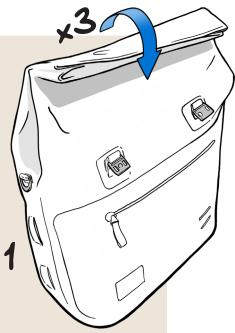
1\_Chiudere la parte superiore della borsa utilizzando le guide magnetiche. Arrotolare il bordo della borsa tre volte.
